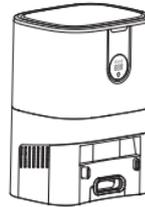
Станция автоматической очистки комбинированного контейнера со встроенной зарядкой
