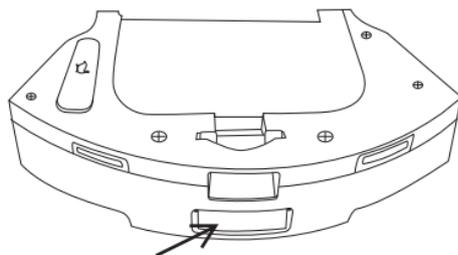
3. Проверьте, не заблокировано ли движение металлического блокиратора, приподняв его тонкой плоской отверткой или пальцем.
