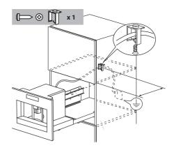
Установите машину на направляющие, убедившись, что их выступы зашли в предназначенные для них гнезда, затем закрепите ее с помощью винтов, входящих в комплект поставки.
