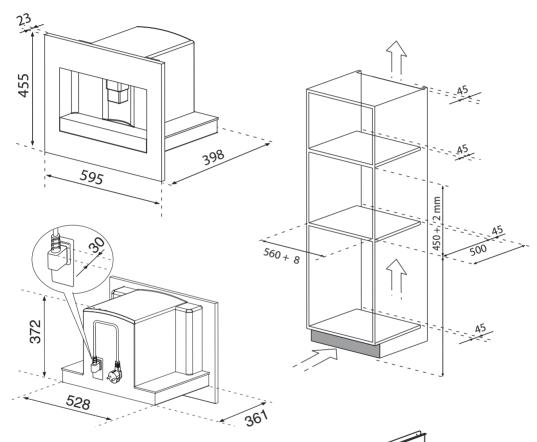
Расположите направляющие по краям отсека для встраивания как показано на рисунке. Закрепите направляющие с помощью шурупов, входящих в комплект поставки, затем выдвиньте их на всю длину. Если кофемашина устанавливается над устройством для разогрева продуктов, при установке направляющие учитывайте расположение его верха. В этом случае у кофемашины не будет опорной поверхности.
